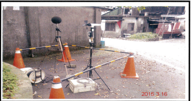
噪音振動監測情形 (104/3/16)
