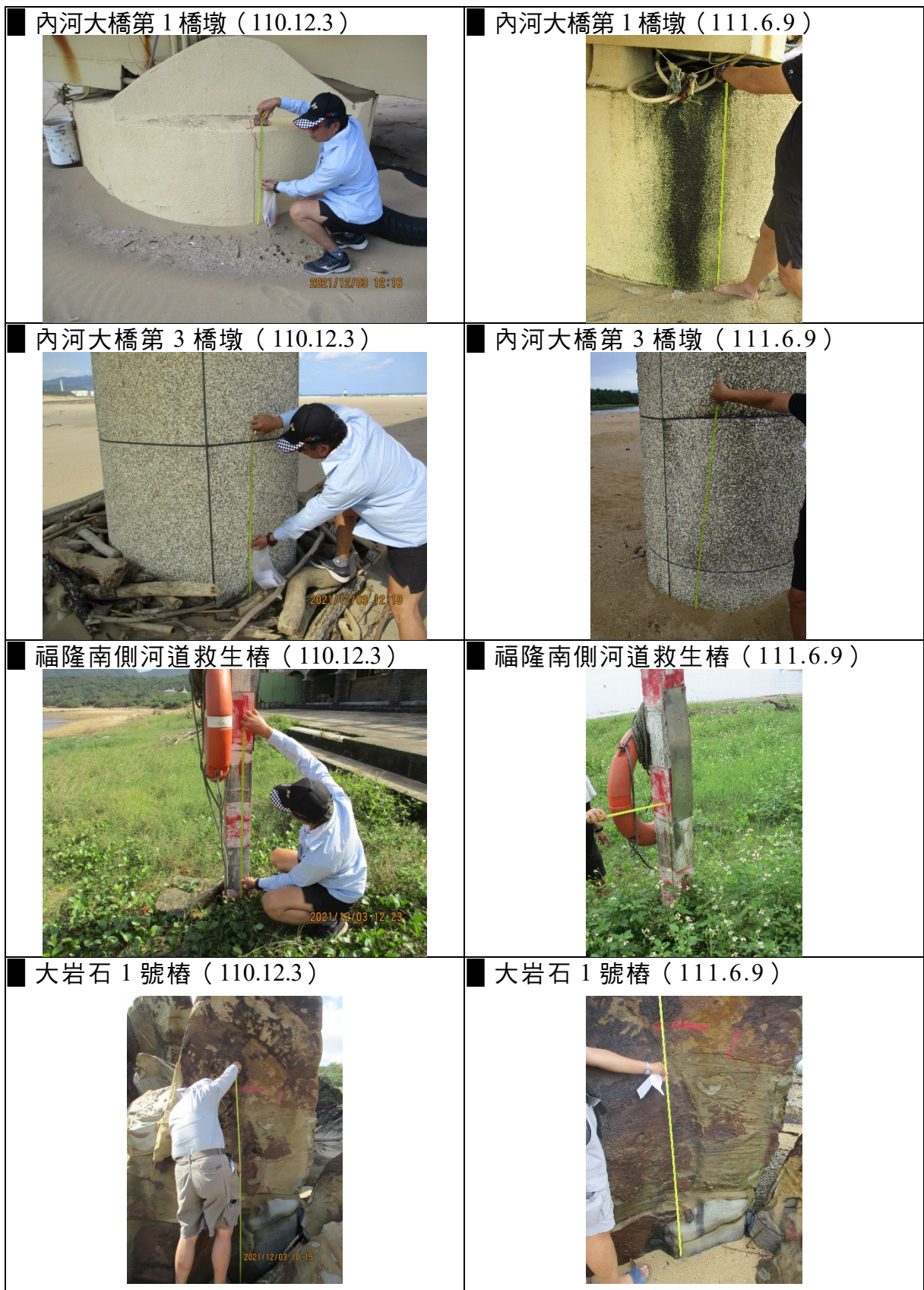
照片 2.5-1 核四封存期間定位樁觀測情形
