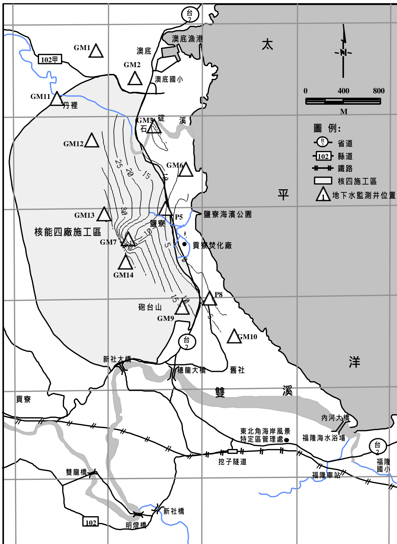
圖 2.8-4 核四施工環境監測地下水89年9月等水位線圖
