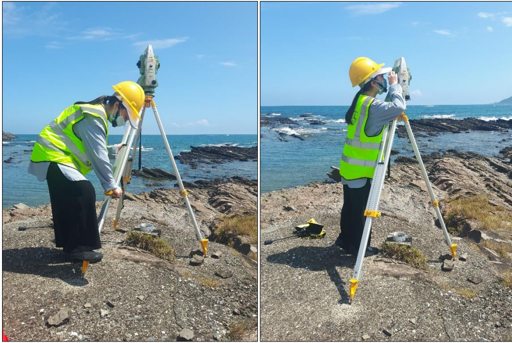
圖 3-2 全站式經緯儀架設於控制點
